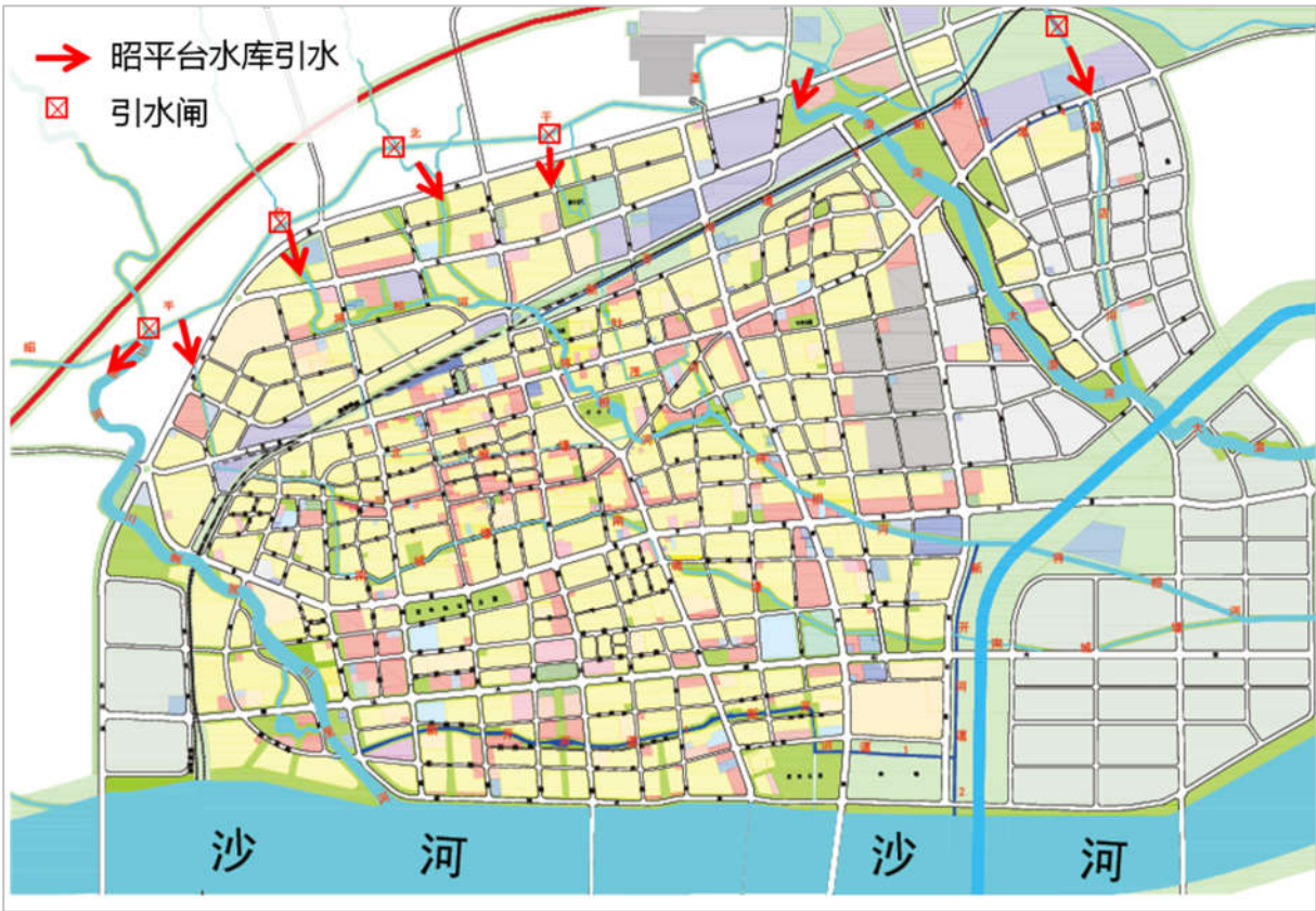
图4-3 方案一昭平台水库引水流向示意图
