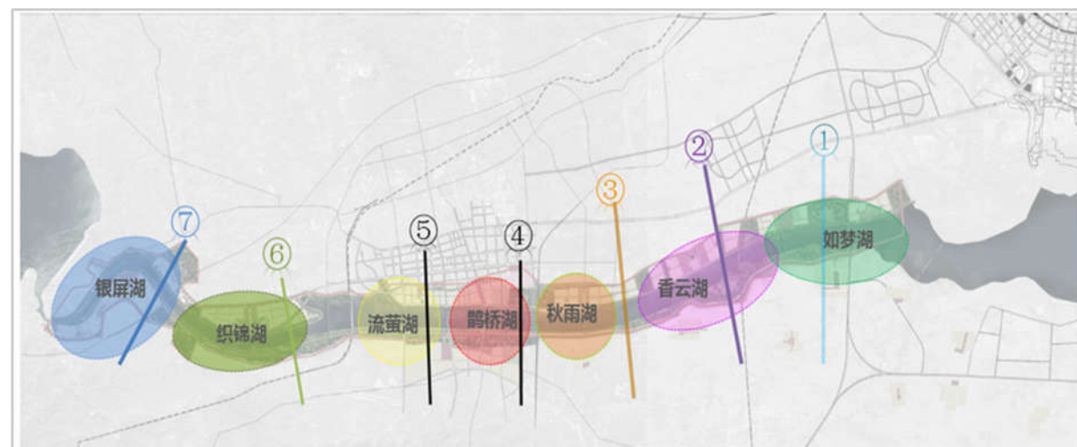
图3-2 沙河拦蓄水建筑物布置图
