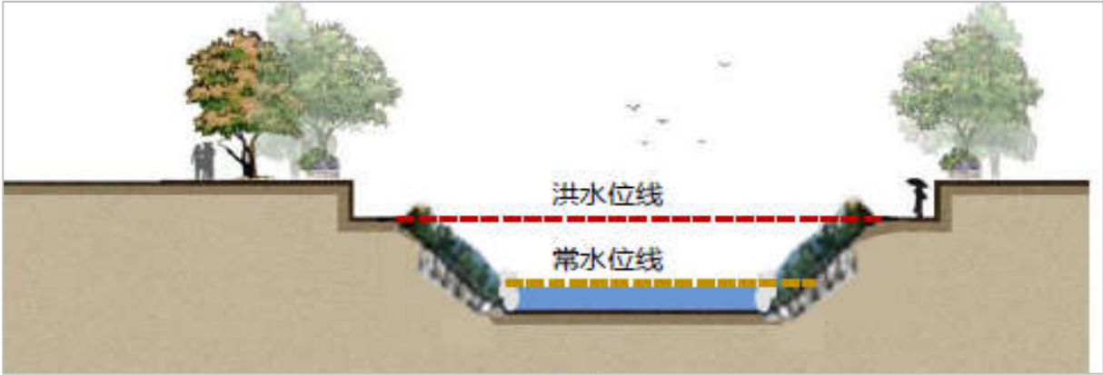
图6-2 生态护坡断面示意图
