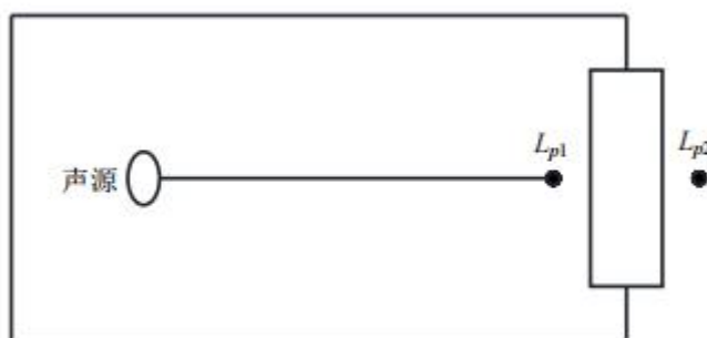
图 6 室内声源等效为室外声源图例
