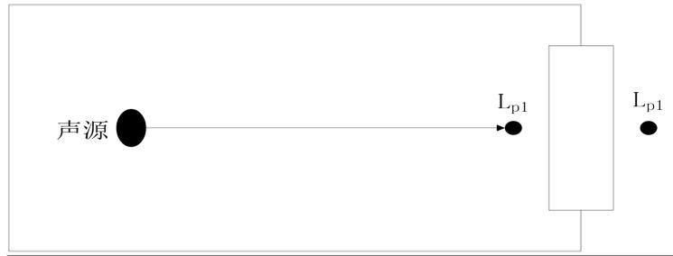
图 4-1 室内声源等效为室外声源图例
